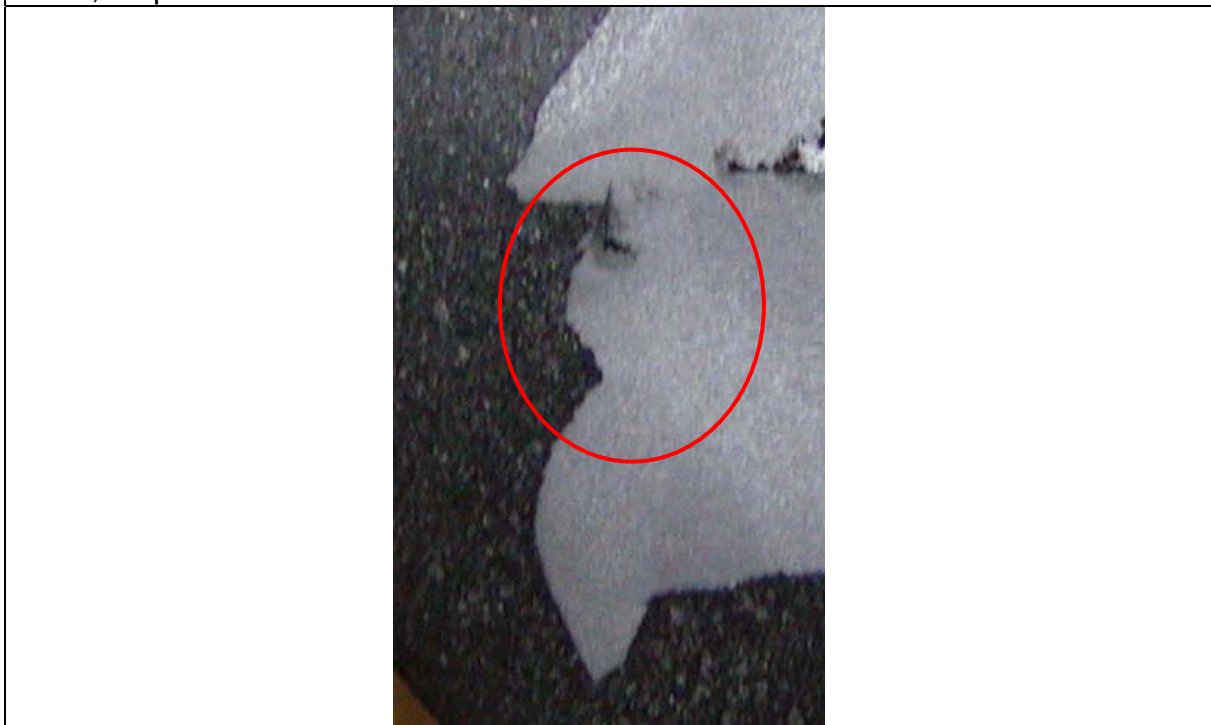
Foto 4- Detalhe da região da fratura (região 1). Notar a mancha escura no material dentro do círculo, que pode indicar a presença de uma inclusão nessa região. Deve-se ressaltar também a existência de um trinca na mancha em questão.
