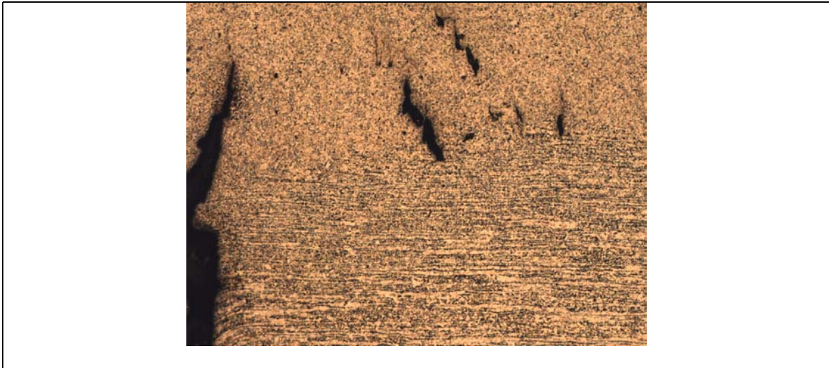
Figura 7- Região 1- Área da interface metal base/cordão de solda. 50x, Ataque nital 2%. Pode-se ver claramente a trinca principal e diversas trincas secundárias no material depositado.
